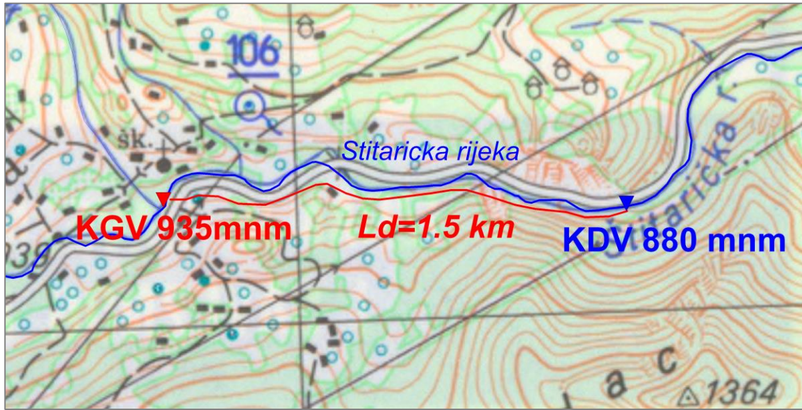
Pregledna karta sa kotama gornje i donje vode i dužinom derivacije R 1:50 000
