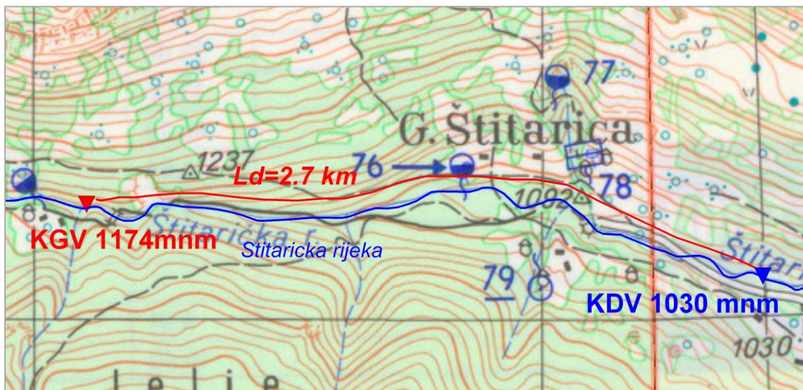
Pregledna karta sa kotama gornje i donje vode i dužinom derivacije R 1:50 000
